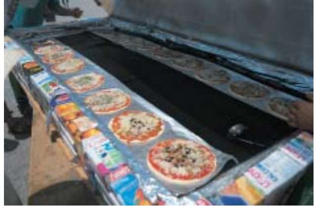
Cocina solar de caja construida con envases de tetrabrik
