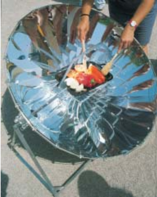
La cocina solar parabólica permite obtener cerca de 1 kW por cada 2 m 2 de superficie de captación
