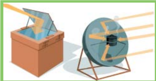
Captación del calor solar por acumulación en un horno solar y de concentración en una parábola
