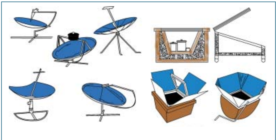
Diferentes modelos de cocinas de concentración (a la izq.) y de acumulación con concentradores (a la dcha).
