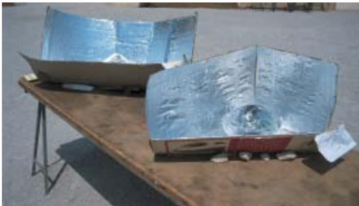
Modelo de cocina solar basada en el concepto de un reflector hecho de cartón forrado de aluminio y un recipiente de vidrio para absorber el calor acumulado
