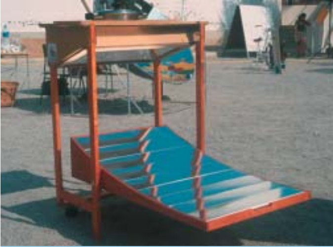
Cocina mixta de acumulación y concentración diseñada por Roger Bernard pensada para cocinar a la sombra
