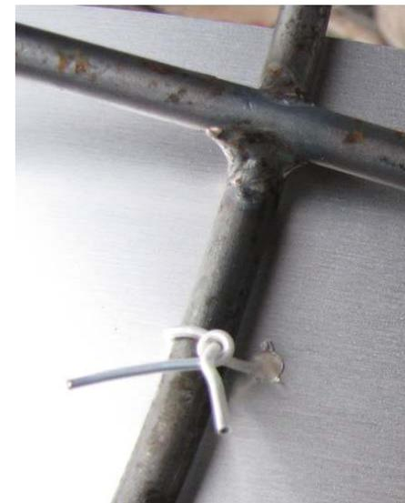
Fijación de lámina (1) con alambre de 70 mm a un anillo del portador del reflector
