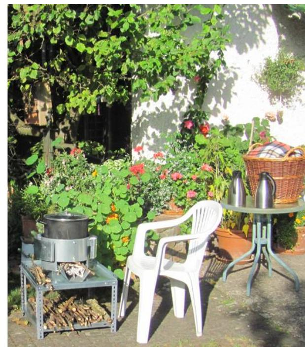
**Fig. 1.** Lugar de trabajo para el hornillo de leña Ben 2 o Ben 3. Dimensiones de la plataforma: 50 cm x 50 cm, altura 33 cm. El estante y la perfilería es la del sistema Vario (Schulte.de) o similar como (mecalux.com)
