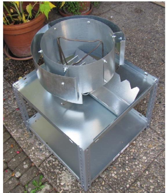
Fig. 2. Estantería atornillada para el hornillo de leña Ben 2 o Ben 3. Las dimensiones de la plataforma: 50 cm x 50 cm, altura 33 cm. El estante y perfilería es la del sistema Vario (Schulte.de) o similar como (mecalux.com)
