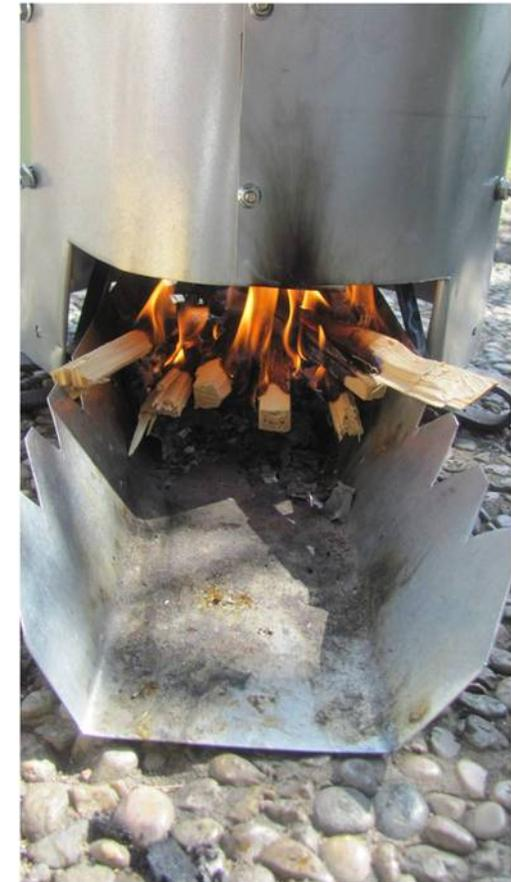
Los hornillos pueden ser fabricados con acero no aleado en talleres simples
